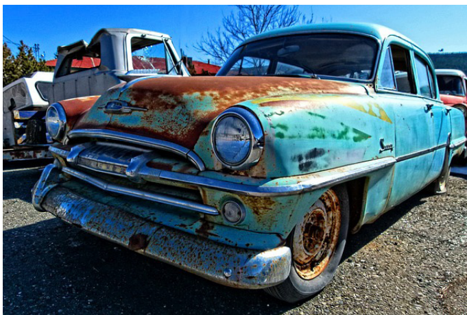
Coche con un grave caso de corrosión generalizada
