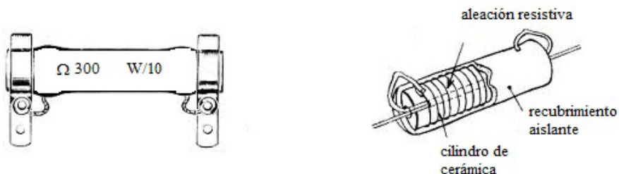
Imagen 2: Resistencia de potencia. El valor óhmico y la potencia se marcan directamente en el cuerpo de la misma.
